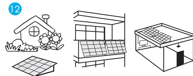
**Schritt 12** Die multifunktionale Halterung kann durch Ihre Konstruktion auch auf dem Boden oder einem (Flach-) Dach aufgestellt und befestigt werden. Mit den Bodenanker können Sie die Halterung (1) z.B. an vorhandenen Befestigungsmöglichkeiten auf Dächern oder am Boden befestigen.
