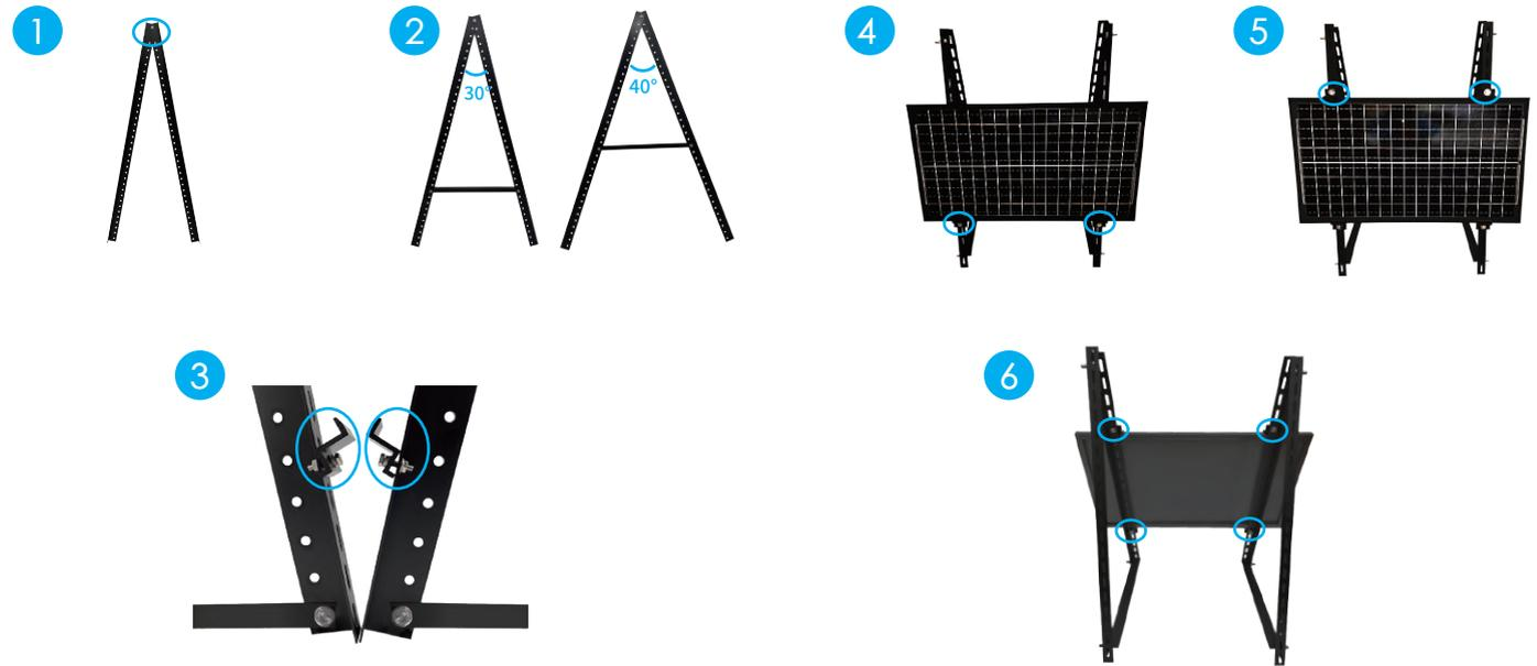
**Schritt 1** Schrauben Sie die zwei langen Halterungen (1-1) zusammen. Nehmen Sie dafür die Sechskantschrauben (1-3) und den beigelegten Maulschlüssel (8).
