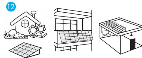
**Schritt 12** Die multifunktionale Halterung kann durch Ihre Konstruktion auch auf dem Boden oder einem (Flach-) Dach aufgestellt und befestigt werden. Mit den Bodenanker können Sie die Halterung (1) z.B. an vorhandenen Befestigungsmöglichkeiten auf Dächern oder am Boden befestigen.
