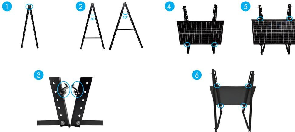
**Schritt 1** Schrauben Sie die zwei langen Halterungen (1-1) zusammen. Nehmen Sie dafür die Sechskantschrauben (1-3) und den beigelegten Maulschlüssel (8).
