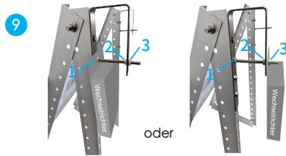
**Schritt 9** Befestigen Sie den Wechselrichter wie in Abbildung 9 gezeigt z.B. in der Mitte oder am Ende der langen Schrauben (6), je nachdem wo der Wechselrichter besser sicher befestigt werden kann.
