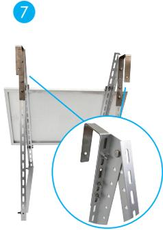
**Schritt 7** Befestigen Sie nun auf beiden Seiten die Haken (5) an der Halterung mit drei der kurzen Schrauben (6). Sollte eine der drei Schrauben die Anbringung an einem Geländer bzw. Balkon behindern, sind auch zwei Schrauben für eine sichere Anbringung der Haken an die Halterung ausreichend.
