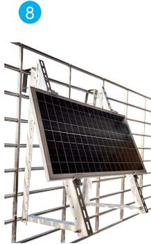
**Schritt 8** Hängen Sie die gesamte Halterung an das Balkongeländer in die gewünschte Position, verriegeln Sie den Haken an der Aufhängungsstange mit den langen Schrauben (6) und befestigen Sie den Wechselrichter z.B. in der Mitte zwischen den Löchern des Hakens an der langen Schraube (6) oder direkt am Ende der langen Schraube (6)- siehe Abbildung 9. Achten Sie bei der Installation des Wechselrichters immer auf eine sichere Befestigung.
