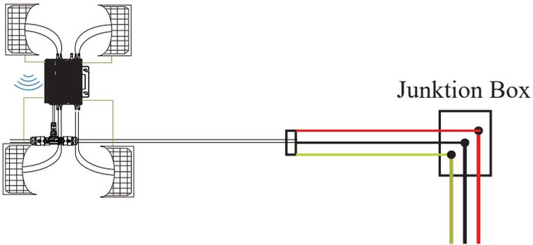
Schritt 5 - Anschließen des Microinverters an die PV-Module
