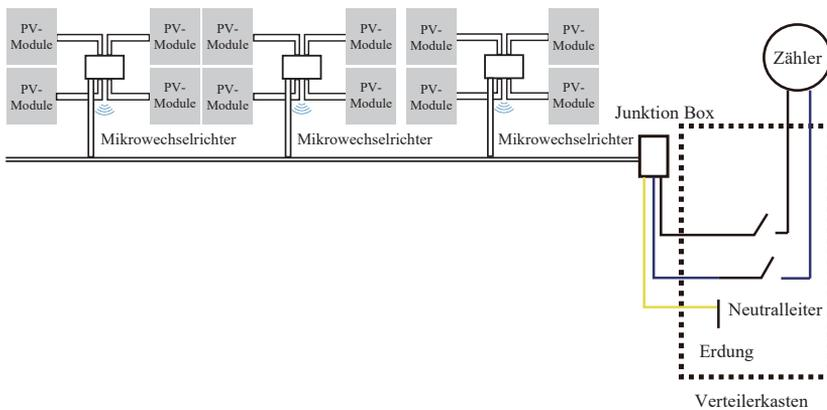
**ACHTUNG:** Der Farbcode der Verdrahtung kann je nach den örtlichen Vorschriften unterschiedlich sein; überprüfen Sie alle Drähte der Anlage vor dem Anschluss an das AC-Kabel, um sicherzustellen, dass sie übereinstimmen. Eine falsche Verkabelung kann zu irreparablen Schäden an den Mikrowechselrichtern führen, die nicht von der Garantie abgedeckt sind.
